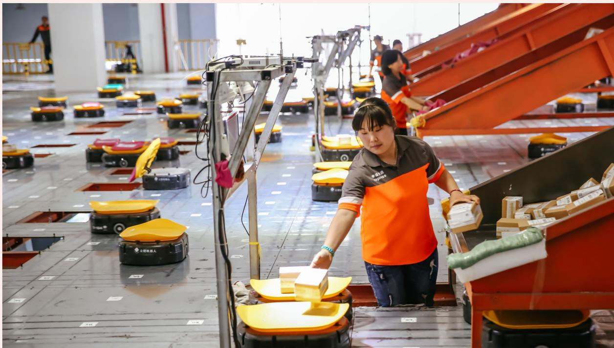
放件员将包裹放在快递智能机器人分拣系统的托盘上，分拣包裹效率大大提高。（张钺 摄）
